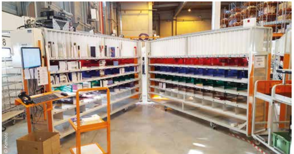
Système de tri collaboratif composé de deux ruchers de 96 cases chacun déployé par Komoto chez Sodis.
