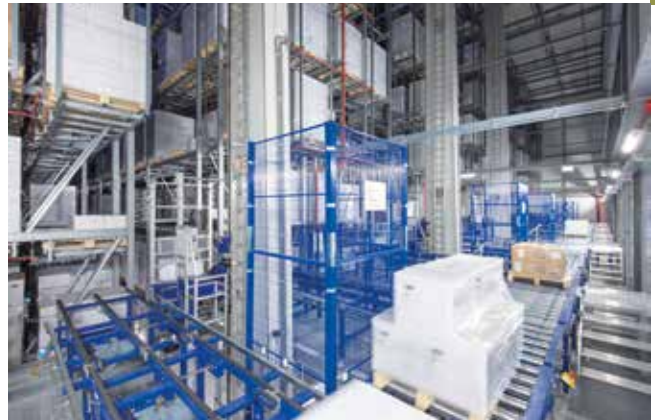
Le rayonnage de six allées offre de la place pour 17 420 palettes. Les transstockeurs sont de type Viapal.
