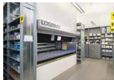
La tour de stockage Logimat réduirait de 70 % les temps de trajet des opérateurs.
