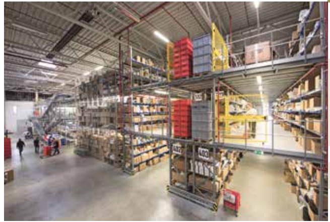
Vue intérieure du centre logistique de Krefeld, avec stockage sur trois niveaux et convoyeur à rouleaux.
