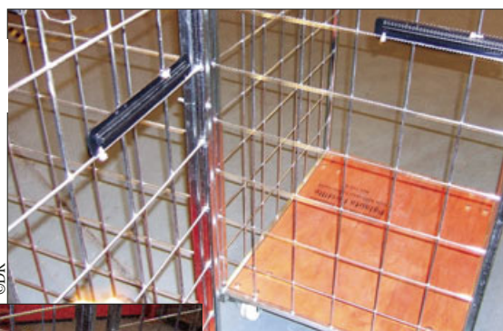
Étant donné la présence de métal et la fréquence utilisée (868,5 MHz), Capgemini a particulièrement étudié l'emplacement du tag RFID (en noir sur la photo). Sachant que les cages sont déplacées par des chariots de manutention, deux positions seulement ont été retenues sur les six étudiées.
